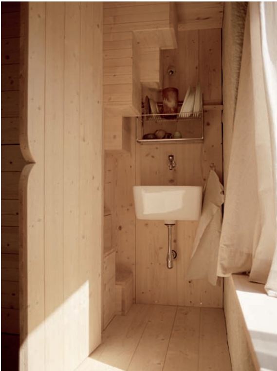
Ein Waschbecken findet Platz unter der steilen Sambatreppe.
